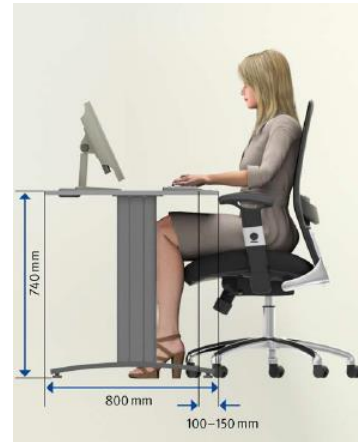
Zusammenhang Bildschirmtiefe/Arbeitsflächentiefe Quelle: DGUV-I 215-410
