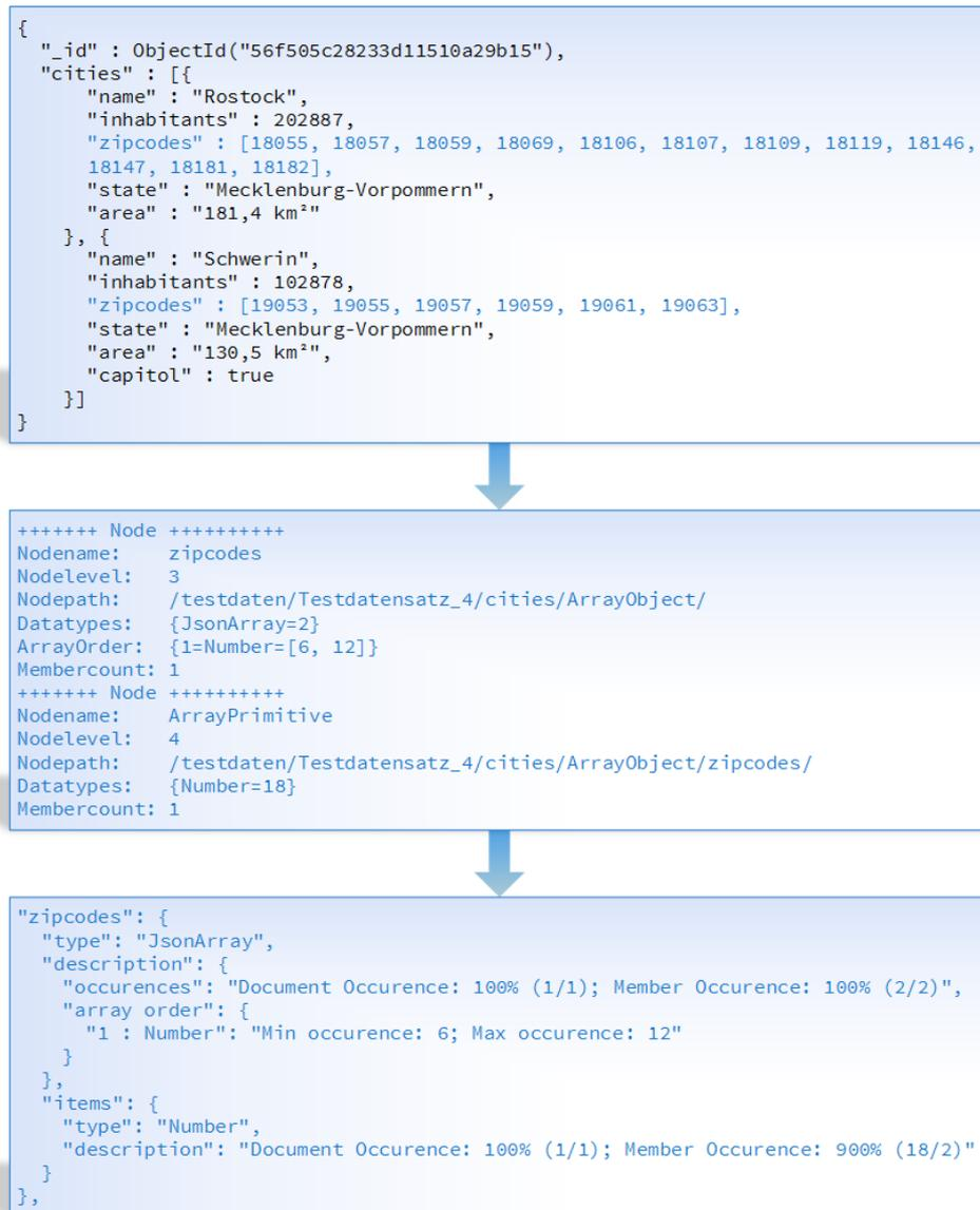
Abbildung 17: Schritte vom JSON Dokument zum JSON Schema
