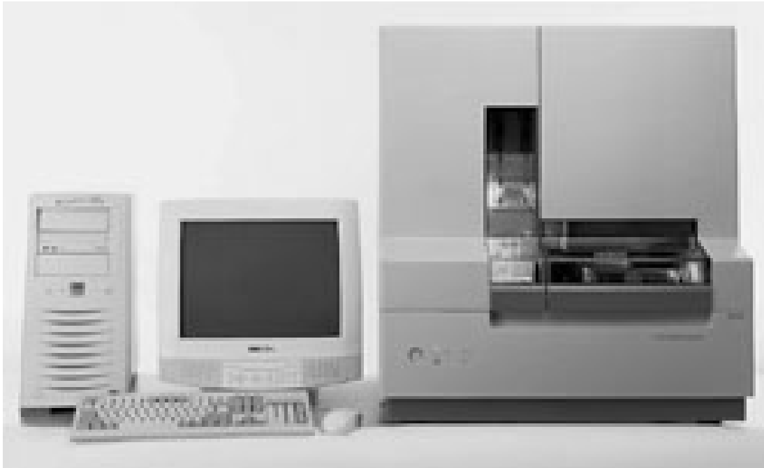
Abbildung 3: Der 145.000 US$ teure Sequenzierautomat „ABI PRISM®3100 Genetic Analyzer“ der Firma Applied Biosystems sequenziert DNS-Stränge mit einer Länge von max. 750 Basenpaaren in 16 parallel arbeitenden Kapillaren [1].
